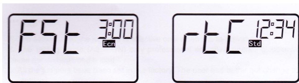
Obr.4:Filtrace nastavena na 3hod
